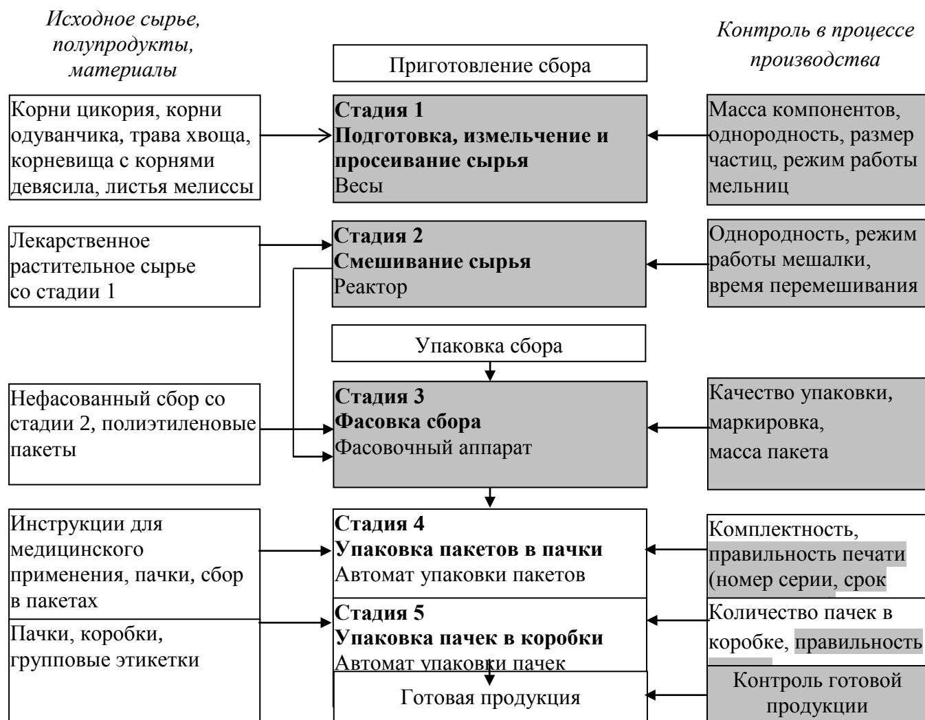
Рис.1. Блок-схема технологического процесса изготовления сбора антидиабетического действия
